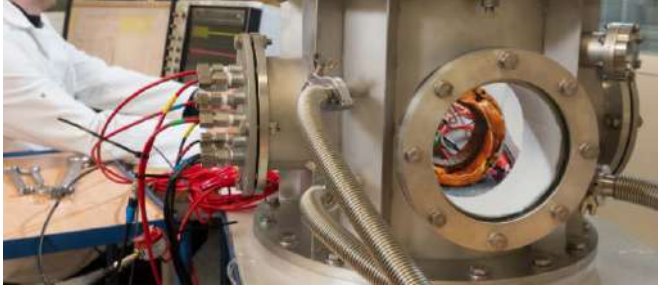
Cabine de détection de décharges partielles © IRT Saint Exupéry
