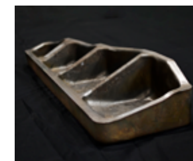
Démonstrateur en alliage TA6V en fin de gamme de transformation à chaud, après ébavurage - L = 800 mm, masse : 32kg
