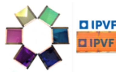
Mini-modules de pérovskite de 16 cm 2 semi-transparents colorés fabriqués à l'IPVF.
